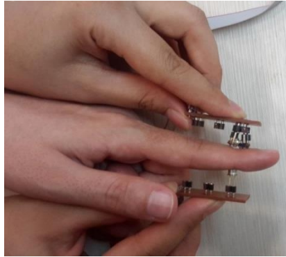
شکل ۵: نحوه قرارگیری سنسورها روی دست در حالت عبور
