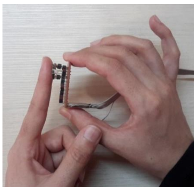
شکل ۷: نحوه قرارگیری سنسورها روی دست در حالت بازتاب
