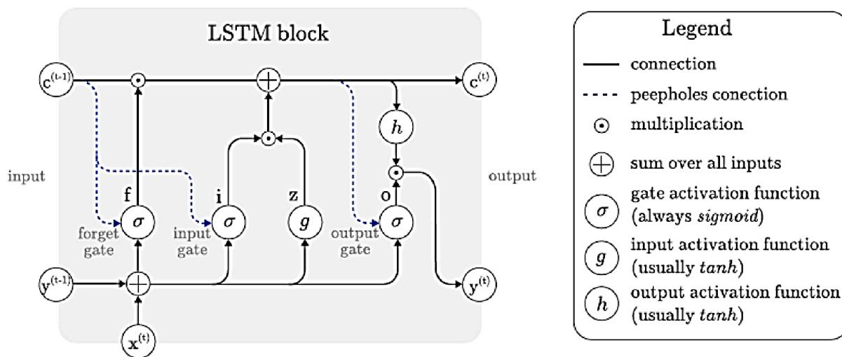
شکل ۱: ساختار یک بلاک LSTM [۳۲]
